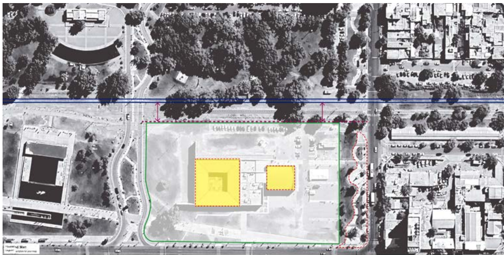
— Vías ferroviarias □ Área de intervención: Delimitación del lote del Museo Nacional de Bellas Artes □ Áreas Restringidas para su intervención □ Área parqueada consolidada del espacio público. □ Retiro obligatorio de 17 metros desde las vías
